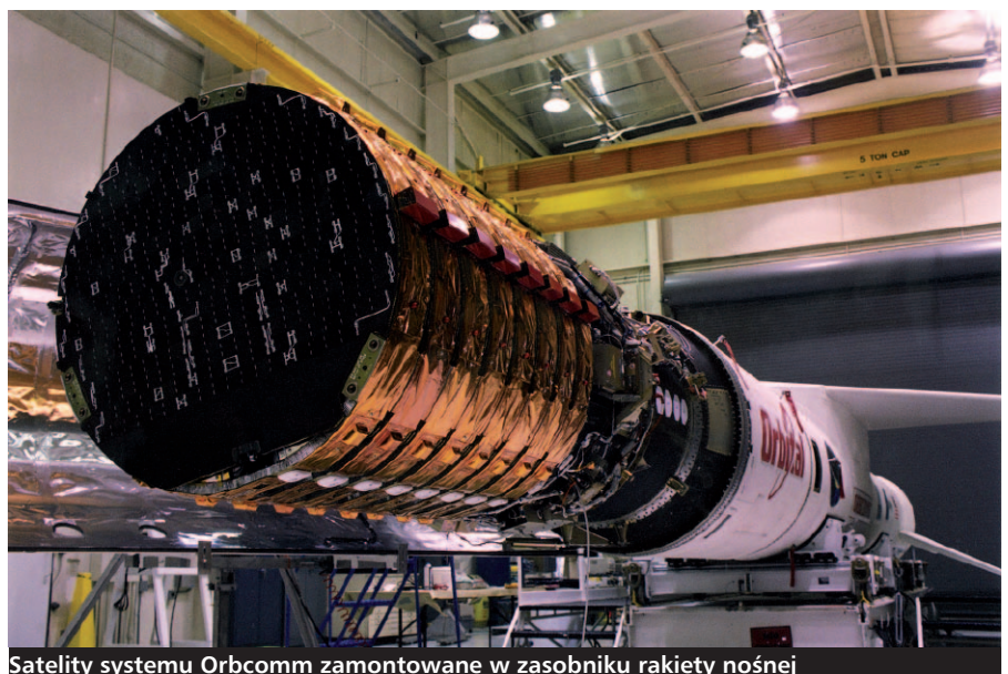
Satelity systemu Orbcomm zamontowane w zasobniku rakiety nośnej
