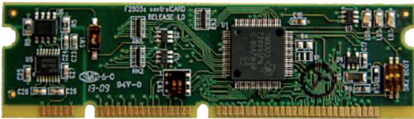
Rys. 7. Płytką Piccolo Control Card z mikrokontrolerem TMS320F28035
