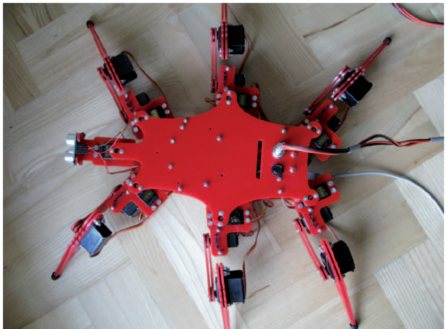
Fot. 4. Robot Maniek w widoku od góry. Widać wszystkie 19 serwomechanizmów
