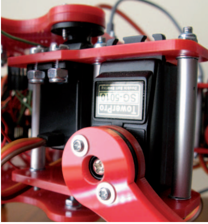
Fot. 2. Płytki utrzymywane są w stałej odległości przez tuleje dystansowe
