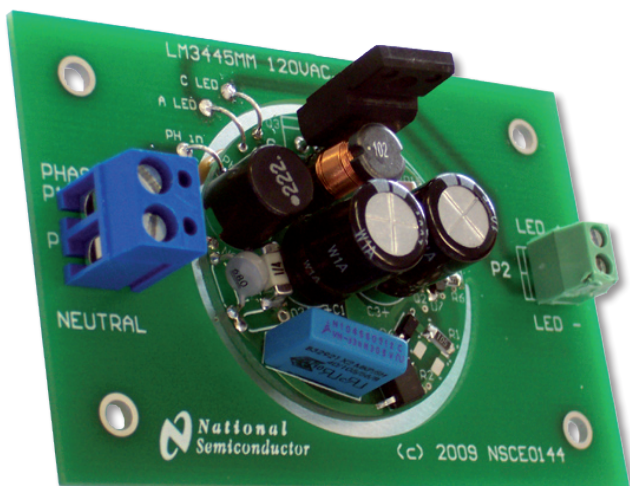
Fot. 4. Przykładowa aplikacja LM3445 do umieszczenia w obudowie żarówki E27
