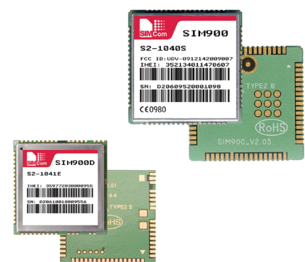
Fot. 1. Porównanie wielkości modułów SIM900 i SIM900D
