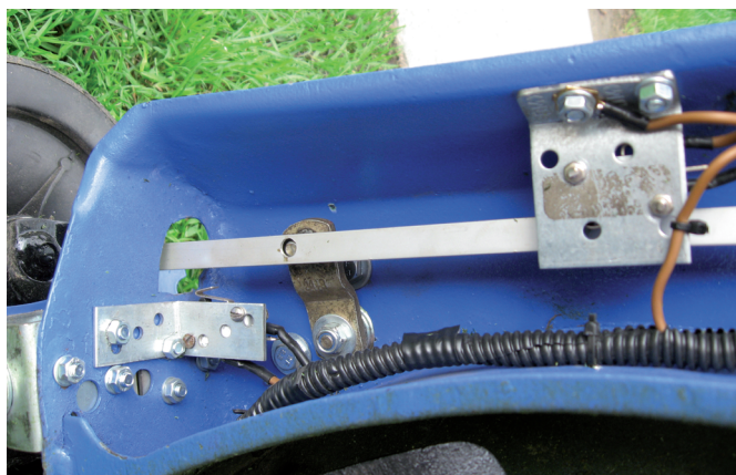
Fot. 9. Mechanizm skrótu kół przednich: widok od spodu
