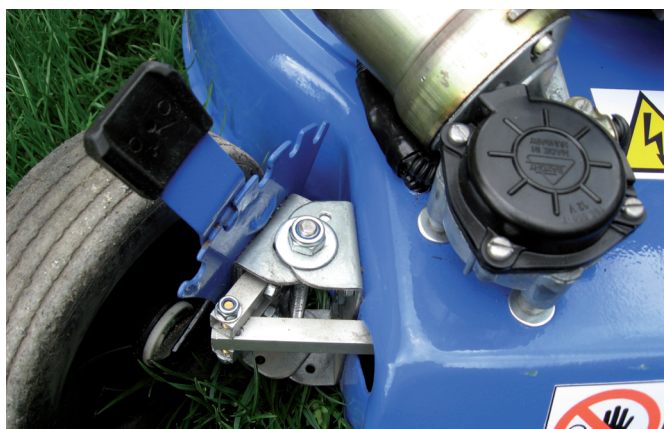
Fot. 10. Mechanizm skrótu kół przednich: widok od góry
