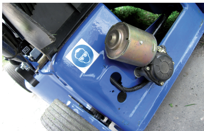
Fot. 7. Realizacja napędu kół tylnych: widok silnika
