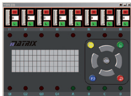
Rys. 12. Panel symulacji sterownika MIAC
