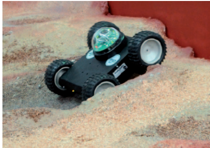
Fot. 7. MOBOT-EXPLORER A1 z zamontowanym dalmierzem triangulacyjnym na obrotowej głowicy
