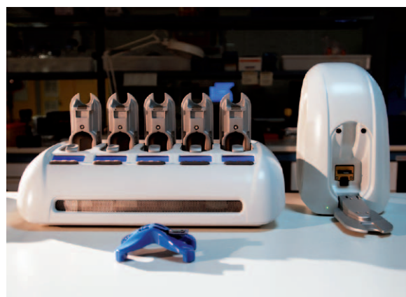
Fot. 1. Biochipowe laboratorium VereFlu opracowane przez firmę Veredus Labs
