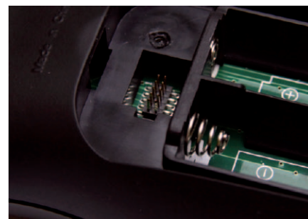
Rys. 2. Złącze programatora radiowego pilota zdalnego sterowania
