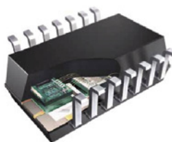
Rysunek 54. Układ TPMS typu SP37 (Infineon)
