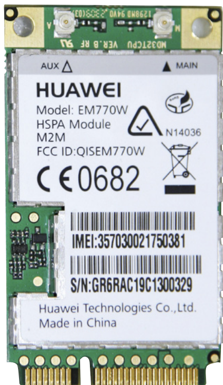
Fotografia 2. Moduły z linii MI są wyposażone w interfejsy miniPCle (jak widoczny na zdjęciu EM770W)
