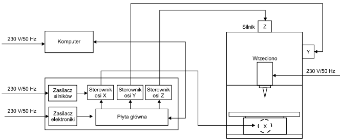
Rysunek 3. Schemat blokowy frezarki
