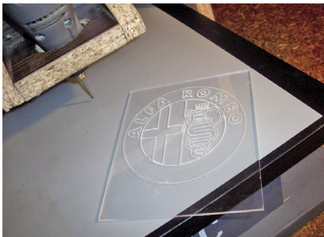
Fotografia 11. Grawerowanie znaku firmowego marki Alfa Romeo
