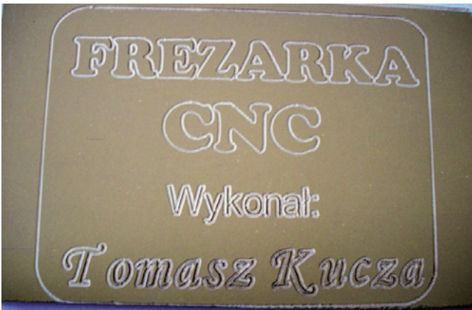
Fotografia 10. Tabliczka wygrawerowana w panelu podłogowym
