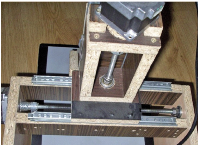
Fotografia 1. Budowa prowadnic osi Y i Z
