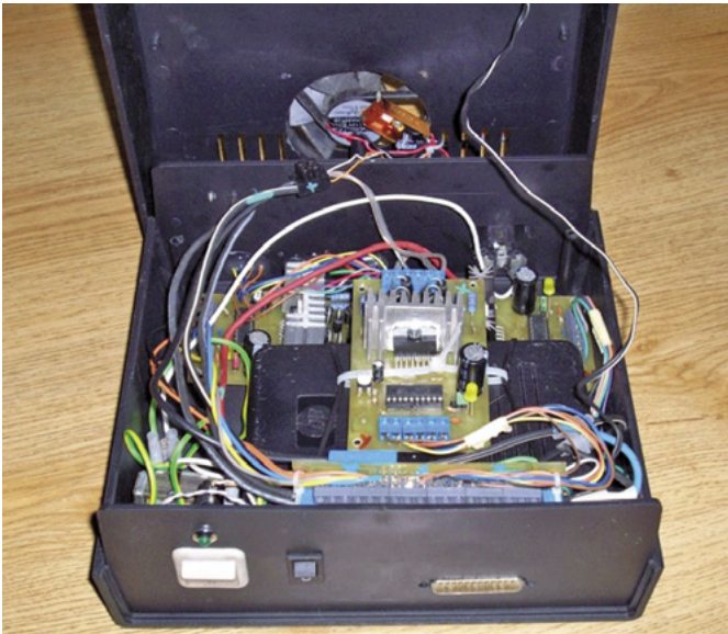
Fotografia 5. Układ sterowania frezarką
