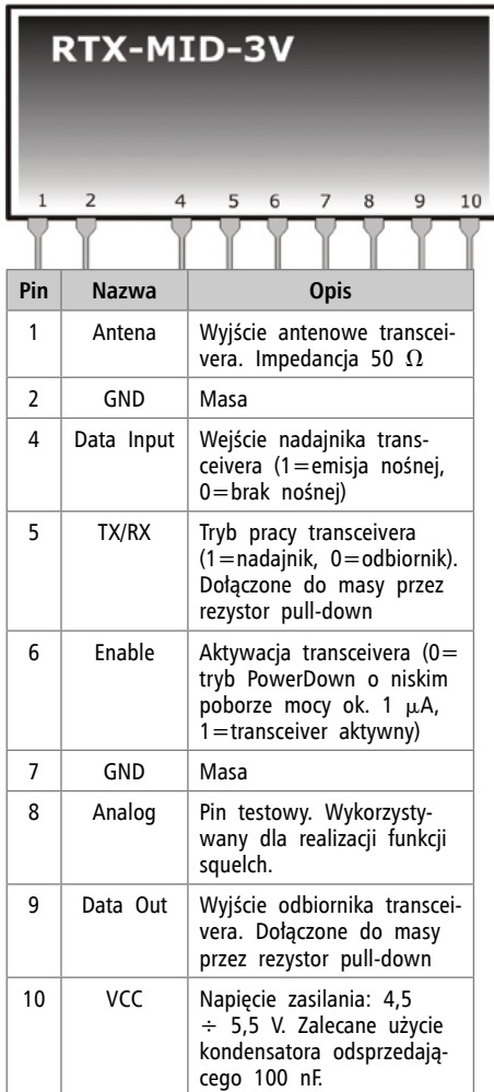
Rysunek 1. Wygląd modułu transceivera z opisem wyprowadzeń
