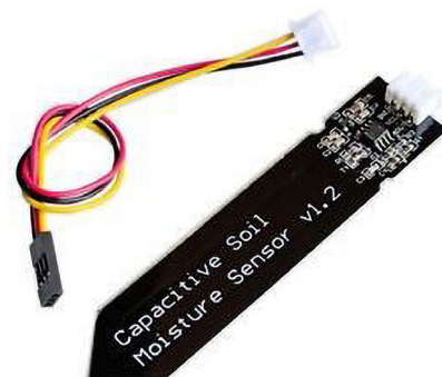
Fotografia 2. Pojemnościowy sensor do pomiaru wilgotności
