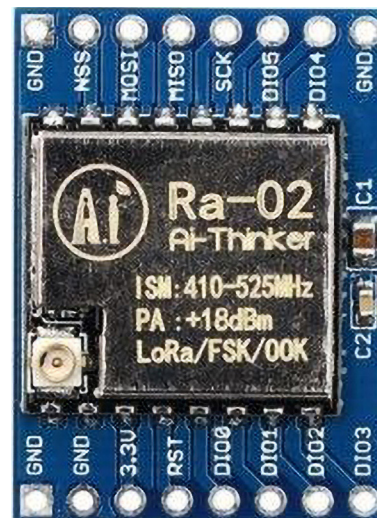
Fotografia 4. Transceiver LoRa wykorzystany w urządzeniu
