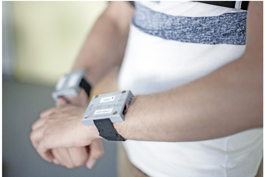
Rysunek 1. Przykładowa aplikacja modułów IMU – zamontowane na nadgarstkach, pozwalają śledzić ruchy rąk
