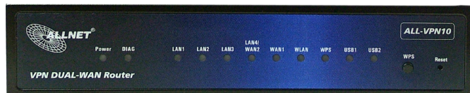
Fotografia 3. Płyta przednia routera z elementami sygnalizacyjnymi
