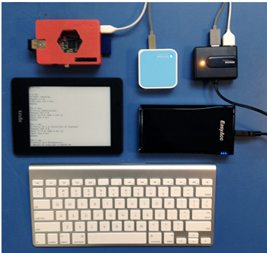
Fotografia 12. Połączenia pomiędzy elementami KindleBerry w wersji bezprzewodowej
