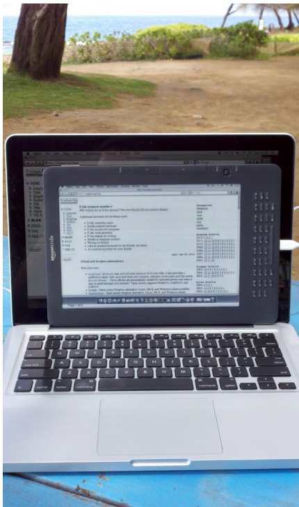
Fotografia 13. Kindle z okienkami, w roli wyświetlacza od laptopa
