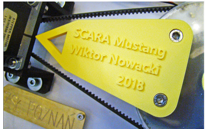
Fotografia 14. Znacznik przeznaczony do zerowania położenia ramienia
