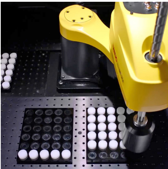
Fotografia 2. Robot klasy SCARA realizujący zadanie pick &amp; place
