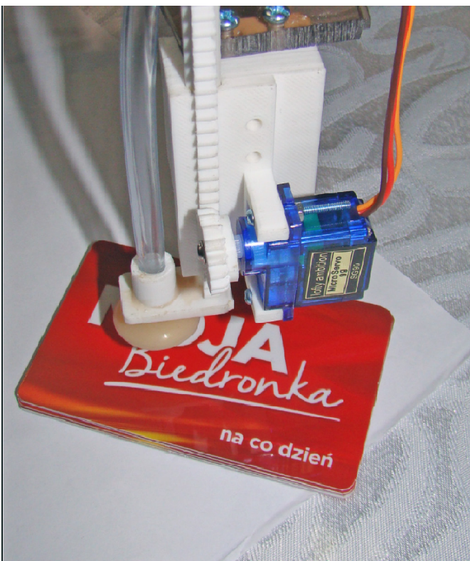
Fotografia 21. Robot realizujący aplikację pick &amp; place
