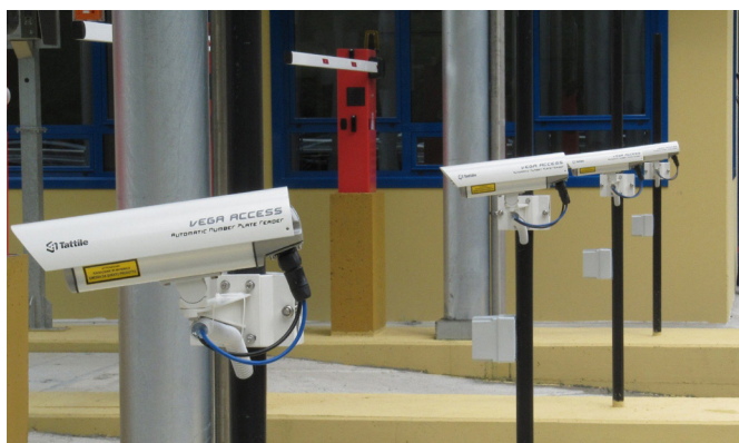
Fotografia 1. Czytniki tablic rejestracyjnych na bramce poboru opłat w Bergamo
