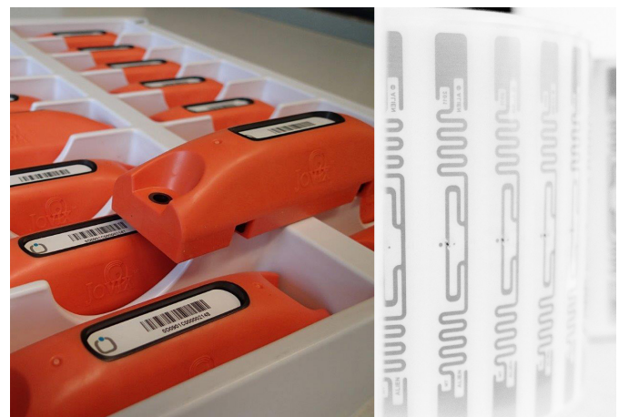
Fotografia 8. Aktywny (po lewej) i pasywny (po prawej) tag RFID
