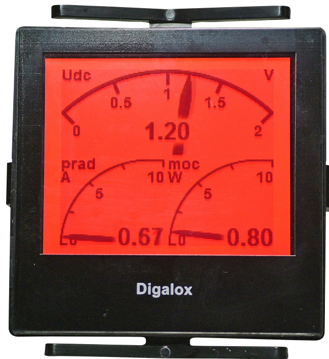
Fotografia 7. Sygnalizowanie alarmu przez zmianę koloru skali
