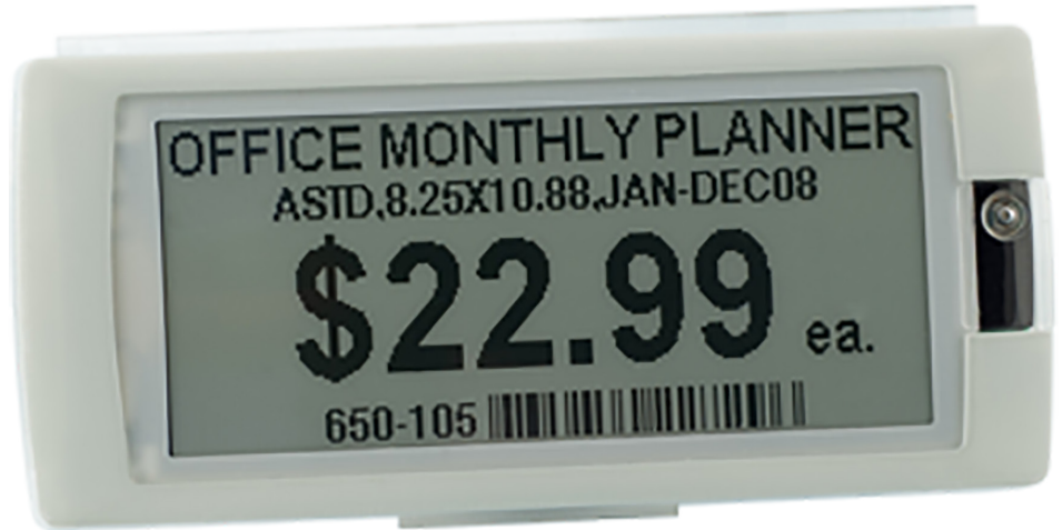
Fotografia 4. Wyświetlacz 2,1" firmy Powertip o ultra małym poborze
