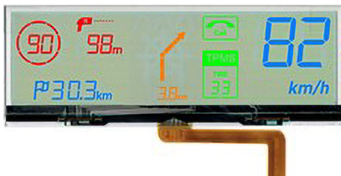
Fotografia 2. Giętki wyświetlacz kolorowy OLED firmy Wisechip
