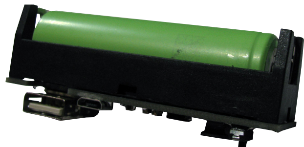
Fotografia 11. Sposób montażu ogniwa Li-Ion
