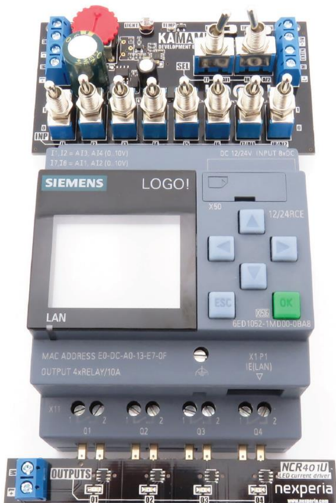
Fotografia 10. LOGO! ze sprzętowym emulatorem otoczenia KA-LOGO!-IO-Simulator
