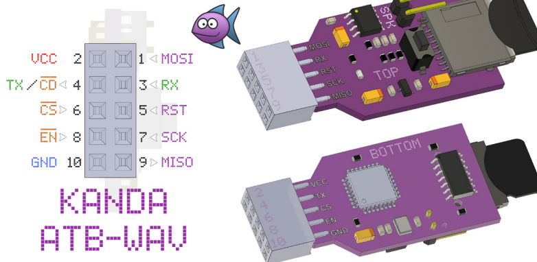
Rysunek 5. Pełny opis wyprowadzeń modułu oraz widok 3D
