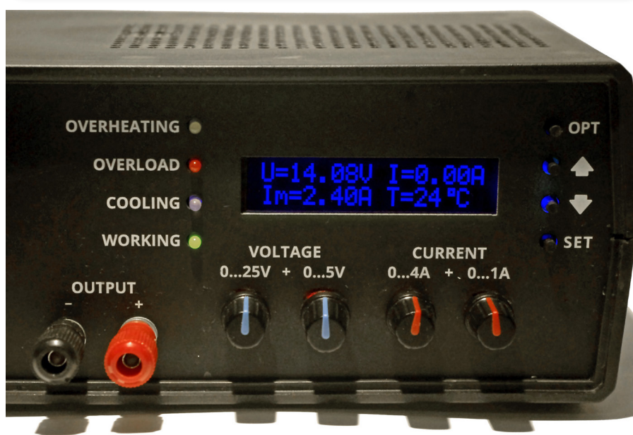
Fotografia 15. Szczegóły montażu elementów na zewnątrz obudowy – panel przedni
