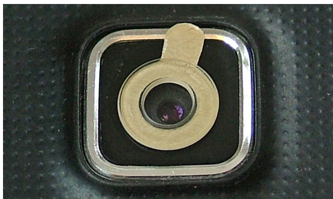
Fotografia 2. Pierścień dystansowy nakładany na obiektyw aparatu
