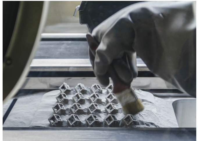
Usuwanie granulatu metalowego z gotowego obiektu
