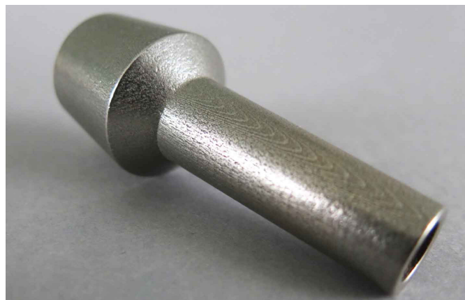
Struktura powierzchni niewielkiej końcówki metalowej
