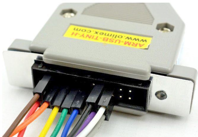
Fotografia 2. Sposób podłączenia przewodów do styków interfejsu ARM-USB-TINY-H
