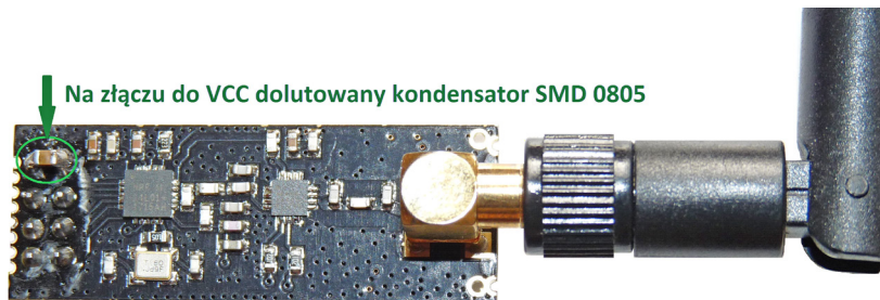
Fotografia 9. Moduł „większy” o oznaczeniu nRF24L01+PA+LNA
