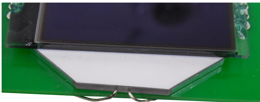
Fotografia 6. Szczegóły montażu podświetlenia ekranu LCD
