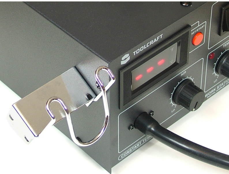
Fotografia 1. Uchwyt na kolbę przykręcony do bocznej ścianki stacji
