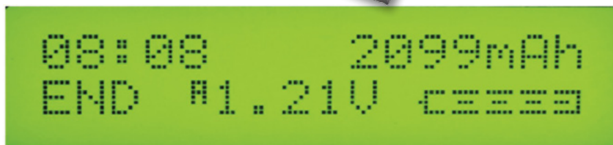
Rys. 1. Informacja prezentowana na wyświetlaczu LCD po zakończeniu pomiaru: (od góry) czas pomiaru, pojemność ogniwa, uśrednione napięcie ogniwa
