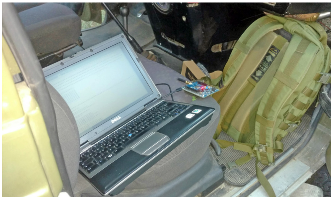
Fotografia 1. Host, czyli centrum dowodzenia całego systemu podczas instalacji w terenie
