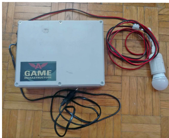
Fotografia 11. Moduł Light z żarówką zasilaną z sieci 230 V
