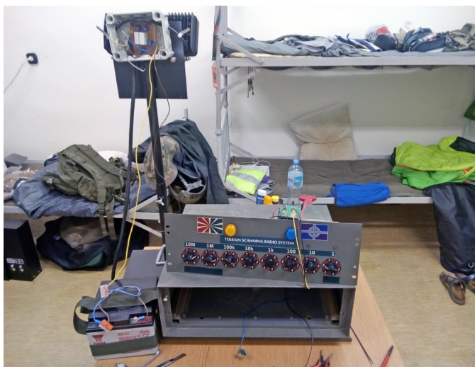
Fotografia 8. Moduł dekodera z zewnętrznymi lampami LED
