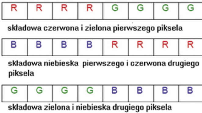
Rysunek 2. Położenie składowych 12-bitowego koloru w pamięci RAM obrazu dla 2 pikseli
