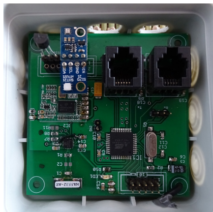
Fotografia 3. Płytkę czujników zamontowaną w obudowie
