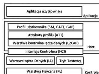
Rysunek 2. Budowa stosu BLE
