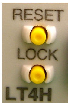
Rysunek 2. Kołnierze zabezpieczające przed przypadkowym naciśnięciem przycisków
