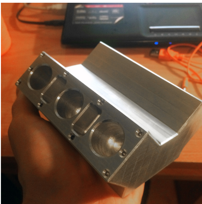
Fotografia 12. Model bloku silnika V6 wykonany za pomocą frezarki opisywanej w artykule
