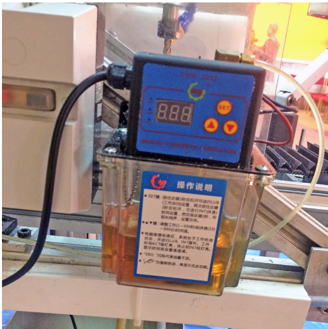
Fotografia 6. Układ automatycznego smarowania przekładni śrubowo-toczących
