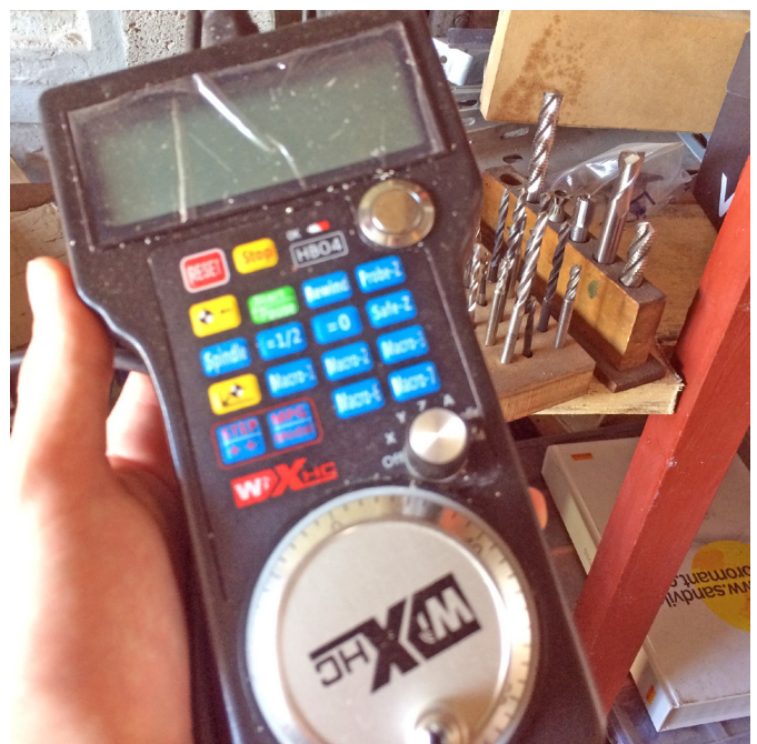
Fotografia 10. Pracą obrabiarki można sterować też za pomocą ręcznego zadajnika impulsów (MPG)
