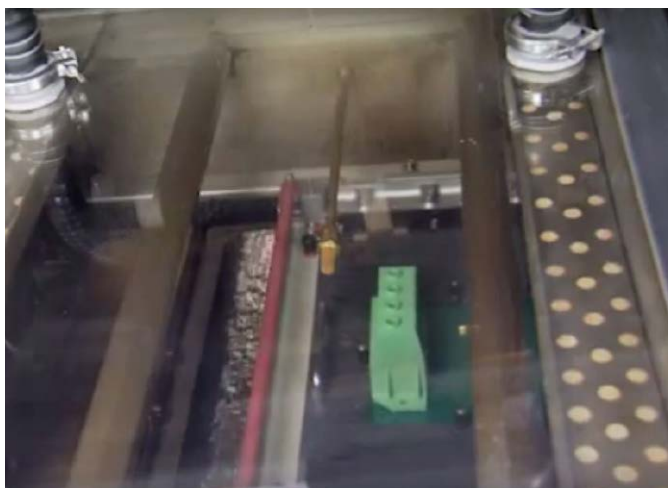
Fotografia 2. Złącze MKDSP 95 można zamontować używając standardowej maszyny do lutowania na fali
