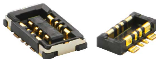
Fotografia 4. Złącze miniaturowe płytka-płytko, montaż powierzchniowy, wykonanie poziome, 6 wyprowadzeń, raster 0,15 mm, wysokość 0,6 mm, szerokość 2,0 mm
