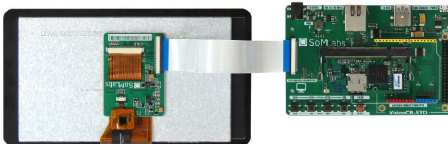
Fotografia 2. Przykładowy sposób dołączenia wyświetlacza LCD-TFT firmy Powertip (SL-TFT-7-TP-800-480) do płyty bazowej komputera embedded
