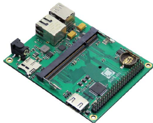
Fotografia 5. Wygląd płytki bazowej VisionCB-IND-HDMI, na której był testowany driver opisany w artykule
