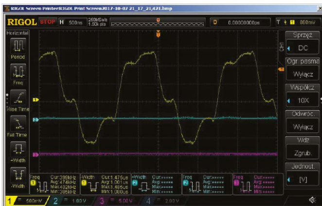
Rysunek 24. Oscylogram przebiegu sinusoidalnego o częstotliwości 400 kHz
