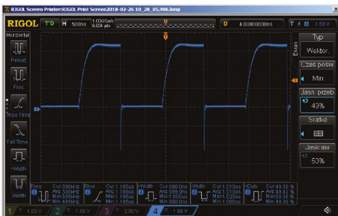
Rysunek 10. Przebieg wyjściowy przy częstotliwości 500 kHz
