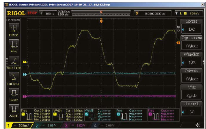
Rysunek 23. Oscylogram przebiegu sinusoidalnego o częstotliwości 300 kHz
