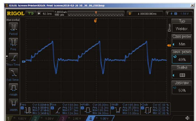
Rysunek 13. Przebieg wyjściowy przy częstotliwości 5 MHz
