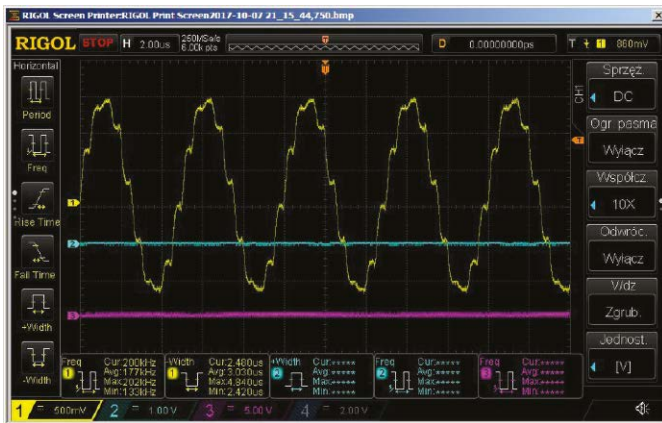
Rysunek 22. Oscylogram przebiegu sinusoidalnego o częstotliwości 200 kHz
