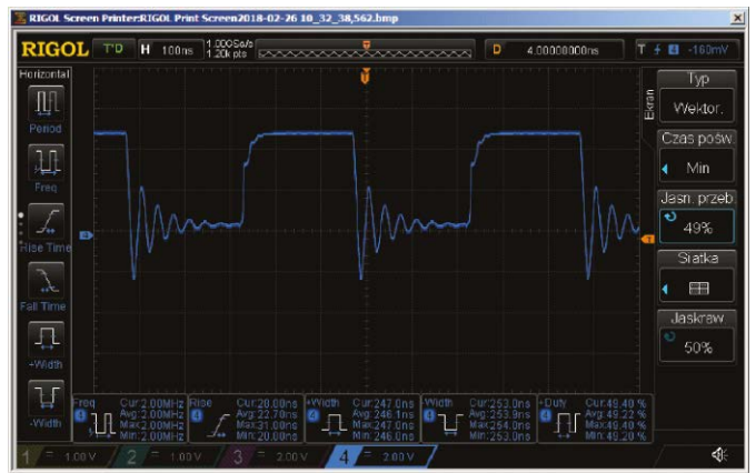
Rysunek 15. Prostokątny przebieg wyjściowy TTL przy częstotliwości 2 MHz
