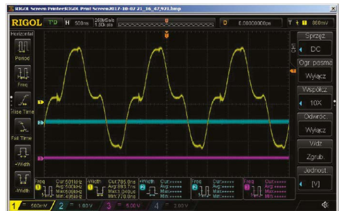
Rysunek 25. Oscylogram przebiegu sinusoidalnego o częstotliwości 500 kHz
