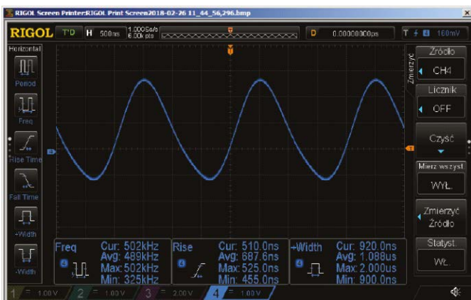
Rysunek 20. Oscylogram przebiegu piłkowształtnego - odwróconego o dużej częstotliwości
