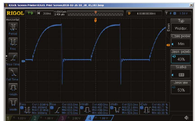
Rysunek 11. Przebieg wyjściowy przy częstotliwości 1 MHz
