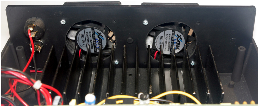
Fotografia 14. Montaż wentylatorów oraz włącznika i gniazda zasilania 12 V DC – widok wewnętrzny obudowy
