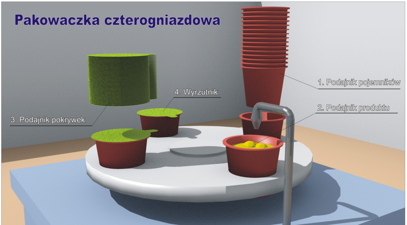
Rysunek 1. Budowa maszyny do pakowania opisanej w artykule
