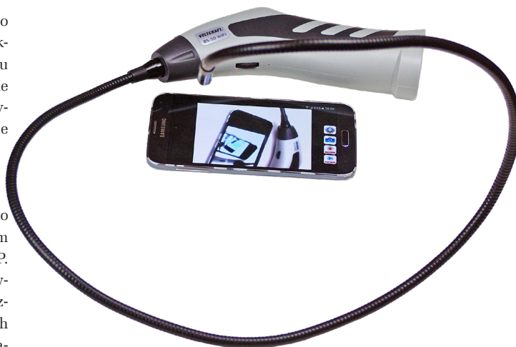
Fotografia 1. Kamera z uformowanym wysięgnikiem
