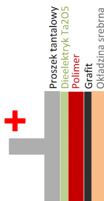
Rysunek 1. Różnica między konwencjonalnymi i polimerowymi kondensatorami tantalowymi: Zamiast MnO_2 (niebieski) te ostatnie mają polimer na katodzie (czerwony). Źródło: Rutronik
