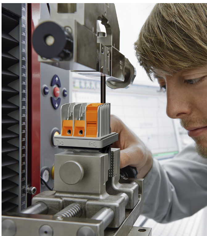
Fotografia 3. Wytrzymałość na wrywanie przewodów została potwierdzona rzetelnymi testami laboratoryjnymi
