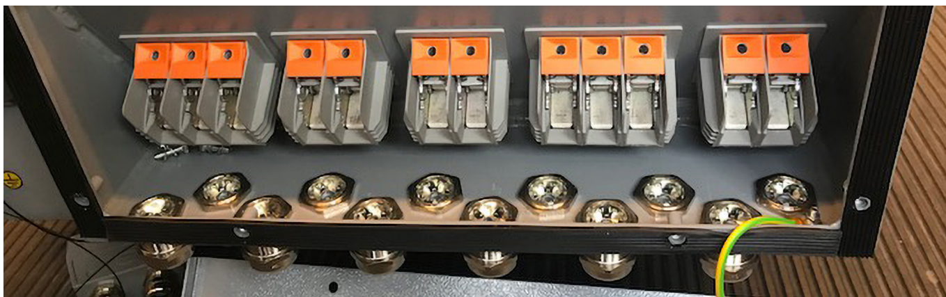
Fotografia 1. Komora przyłączeniowa najnowszego falownika produkcji Eniki. Pojedyncze przewody bez tulejki oczkowej przeplata się przez dławnicę, a następnie wygodnie zapina na terminalach przyłączeniowych
