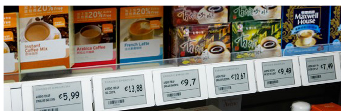
Rysunek 4. Aplikacja Internetu Rzeczy z wykorzystaniem wyświetlacza e-papierowego
