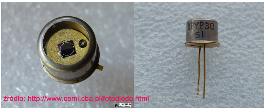
Fotografia 7. Fotodiody polskiej produkcji BPYP30
